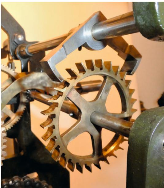
Das Herz der mechanischen Uhr: Anker mit Ankerrad.
